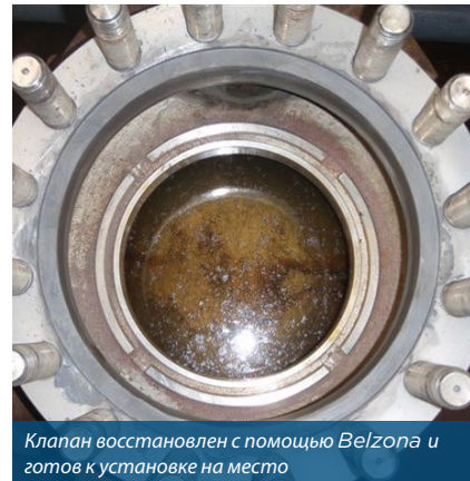
Внутренние поверхности восстановлены и защищены покрытием Belzona
