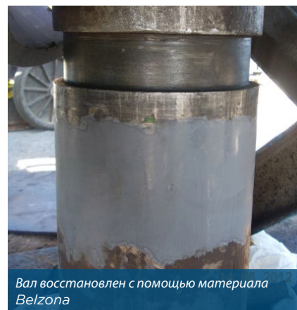
Шпоночный паз и вал отремонтированы с помощью материала Belzona
