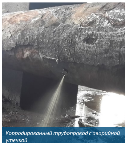
Поврежденный участок отремонтирован методом холодного склеивания Belzona
