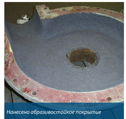
Внутренняя поверхность защищена распыляемым покрытием
