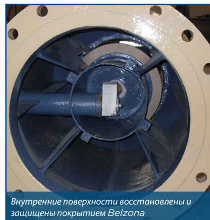
Внутренние поверхности насоса защищены покрытием Belzona для долгосрочной защиты от коррозии
