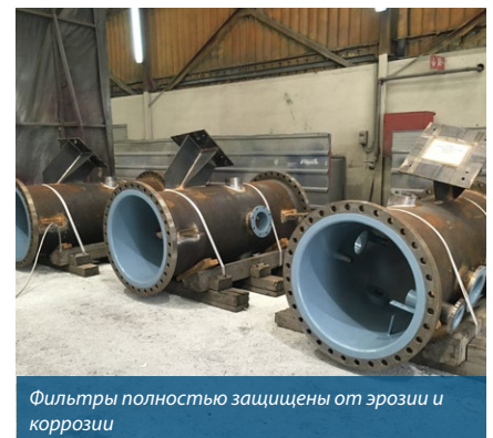
Резервуар защищен покрытием Belzona 5811
