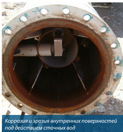
Внутренние поверхности насоса защищены покрытием Belzona для долгосрочной защиты от коррозии
