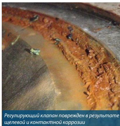
Коррозия и эрозия внутренних поверхностей под действием сточных вод
