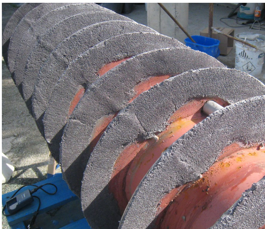
Абразивостойкое покрытие Belzona продлевает срок службы шнекового транспортера
