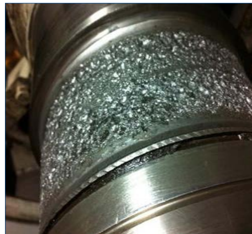
Вал с повреждениями из-за электрохимической коррозии
